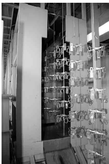
写真-8 前処理設備の出口付近
