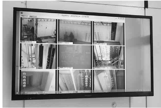
写真-5 塗装ラインをカメラで管理
