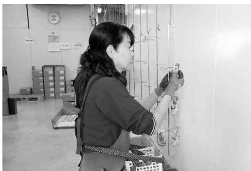
写真-7 自動粉体塗装ラインにワークを着荷
